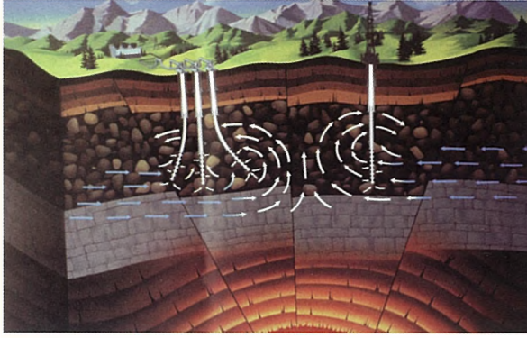
Bir jeotermal sistemin blokdiyagramı
